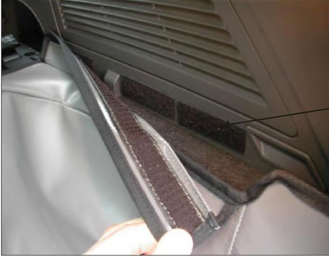
Die Bänder stehen über das Bodenteil hervor, sodass die Verkleidung daran angeklebt werden kann.
